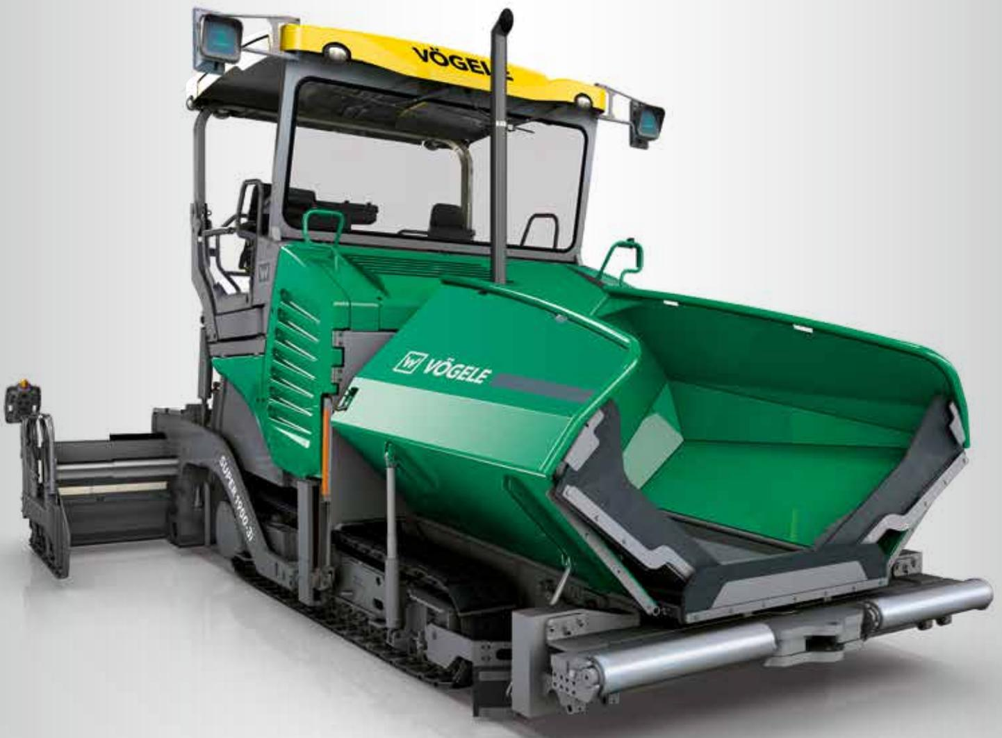
Maximale Einbaubreite 11,00 m
