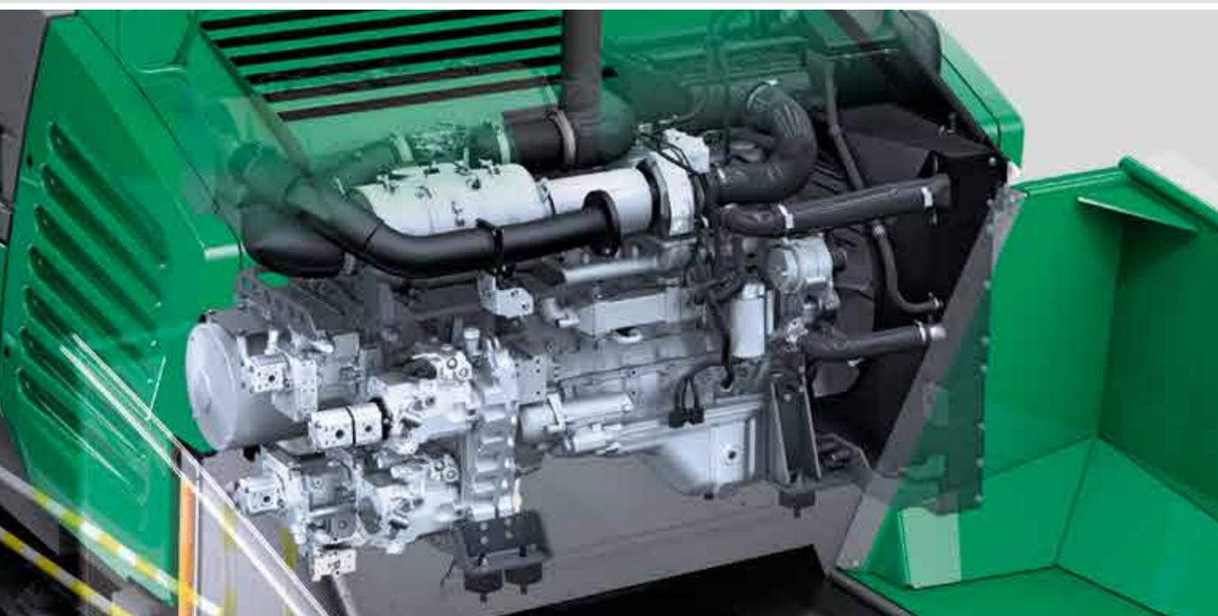
Die Antriebsstation des SUPER 1900-3i erfüllt mit einem Dieseloxydationskatalysator (DOC) und selektiver katalytischer Reduktion (SCR) zur Abgasnachbehandlung die strengen Richtlinien der europäischen Abgasstufe 4 und der US-Norm EPA Tier 4f.
