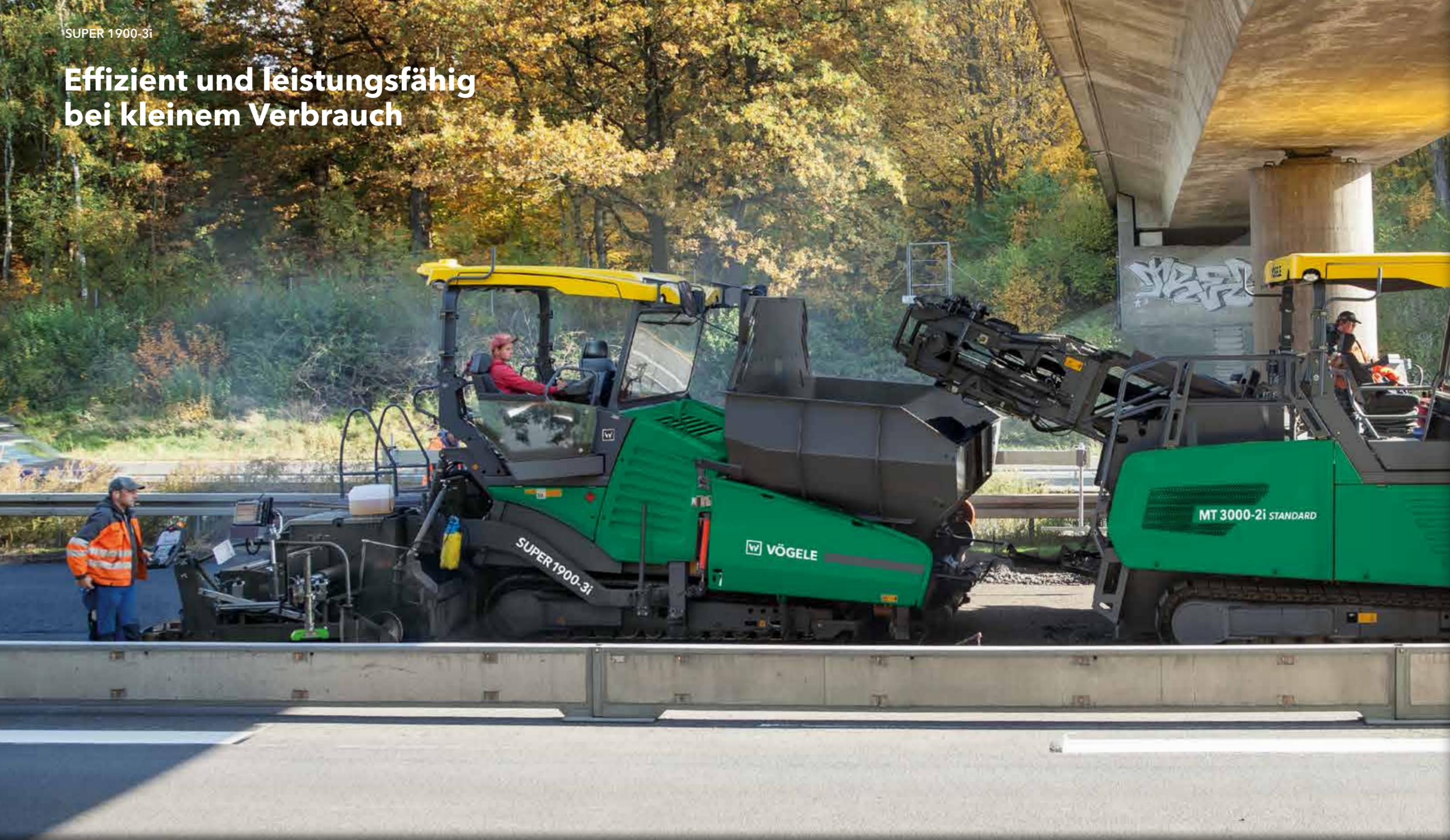
**Die treibende Kraft** des Highway Class Fertigers ist der leistungsstarke Sechszylinder-Dieselmotor mit 142 kW.
