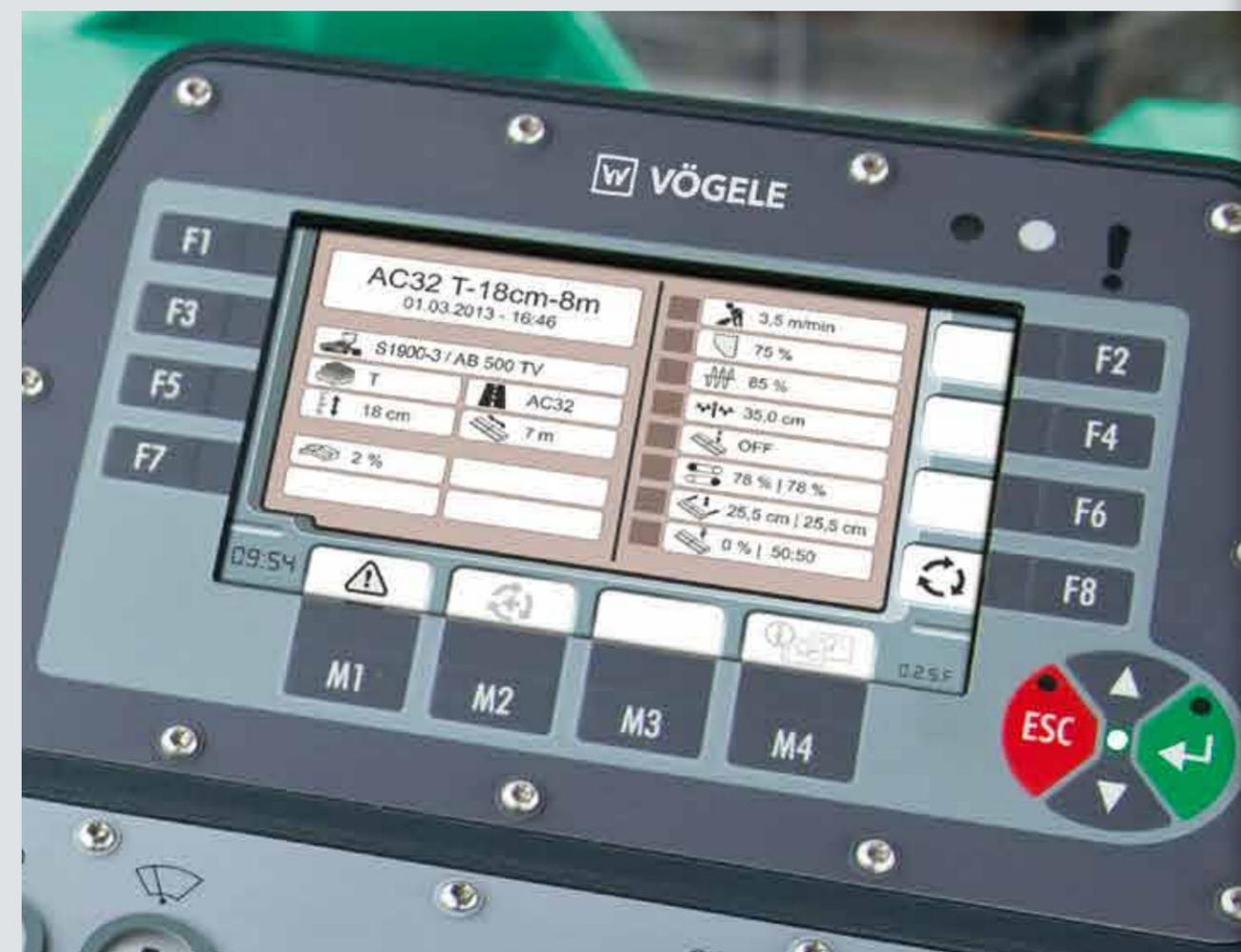
**Die Automatikfunktion** für Einbauprogramme ermöglicht es dem Bedienpersonal, bestimmte Einbauprogramme anzulegen. So können alle wichtigen Parameter für den Einbau einer bestimmten Schicht, z. B. einer Tragschicht aus Asphaltbeton in 18 cm Stärke, abgespeichert werden.
