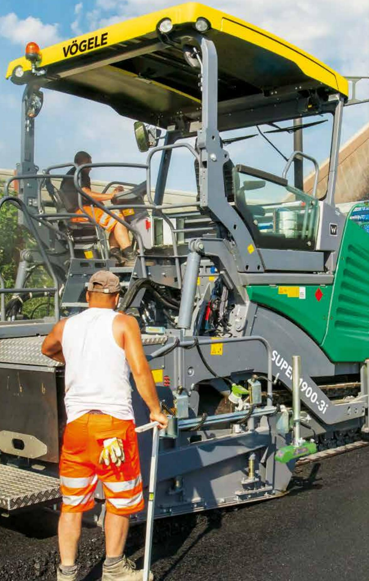
Die **VÖGELE Ausziehbohlen AB 500 und AB 600** sind immer dann erste Wahl, wenn auf der Baustelle beste Einbauqualität bei wechselnder Einbaubreite erzielt werden soll. Mithilfe der hochstabilen Einrohr-Teleskopführung kann schnell und exakt die richtige Arbeitsbreite eingestellt werden.
